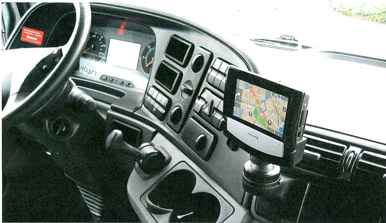
Der Bordrechner im Lkw steht über eine Onlineverbindung mit der Zentrale in Kontakt.
