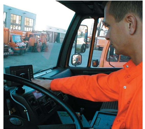
LocalFleet besteht aus einem Telematikserver für die Einsatzzentrale, dem FleetServer, sowie aus den Bordcomputern mit integriertem GPS-Empfänger und übersichtlichem Monitor für die Fahrzeuge. Der Austausch der Daten erfolgt über eine bereits bestehende WLAN-Infrastruktur. Die Streufahrzeuge selbst sind mit Schneepflügen, Tachografen sowie Streupulten ausgestattet, die ihre Daten über eine spezielle Sensorik an den Telematik-Bordcomputer übermitteln.
