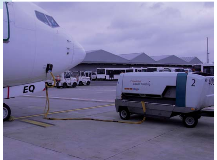
Ground Power Unit (GPU) im Einsatz an einer Boeing 737
